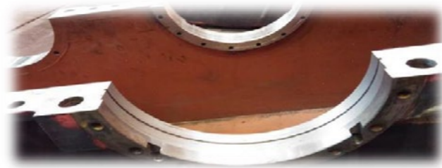
Şekil 15 Burcun Oturacağı Kanalin Açılması
