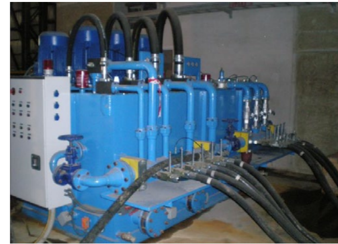
Şekil 7. Örnek bir Flushing Ünitesi ve Mobil Kirlilik Ölçüm Cihazı Görünümü
