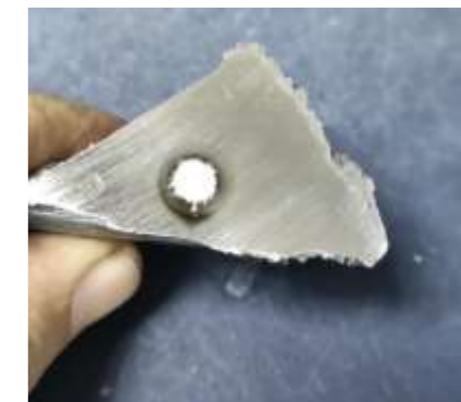
Şekil 1. 5.döküm kontrol numunesindeki hafif gaz boşluğu görüntüsü
