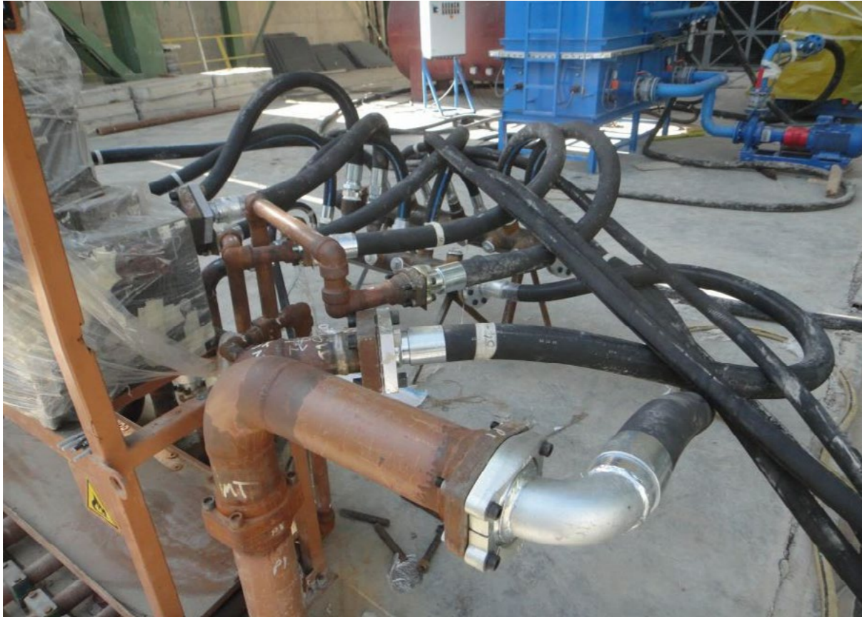
Şekil 3. Sirkülasyon devresi geçici bağlantıları
