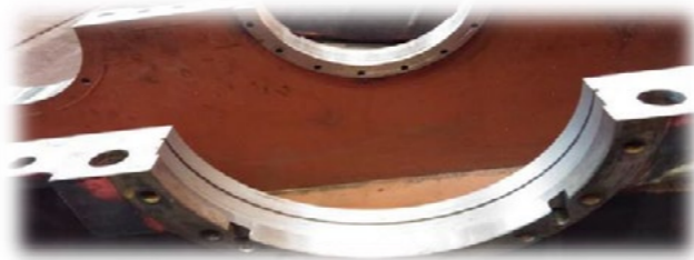
Şekil 15 Burcun Oturacağı Kanalin Açılması
