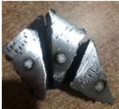
Şekil 3. Oksijen müdahalesi yapılan dökümün kontrol numunesi yoğun gaz boşluklu numune görüntüsü
