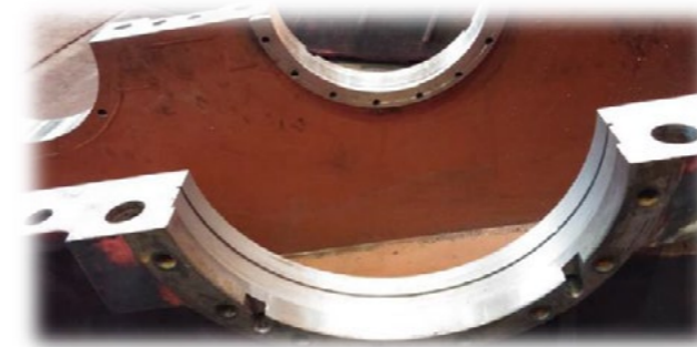
Şekil 18 Gövdede Flanşın Oturacağı Yerin İşlenmesi
