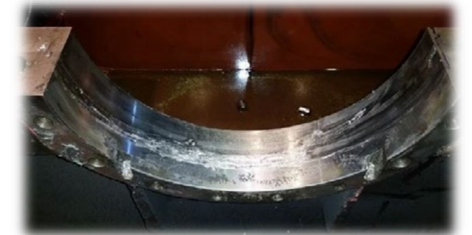
Şekil 11 Hasarlı Redüktör Gövdesi
