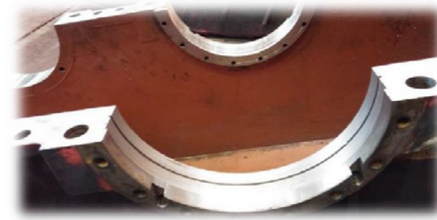
Şekil 18 Gövdede Flanşın Oturacağı Yerin İşlenmesi
