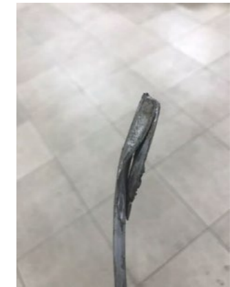
Şekil 5.2 Haddeleme sırasında çapak oluşumu
