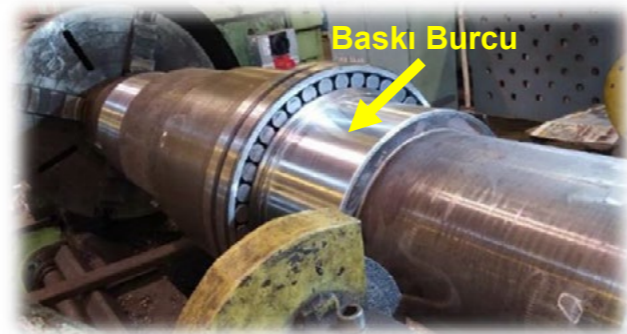
Şekil 16 Çıkış Kademe Milinin Rulmana Göre İşlenmesi
