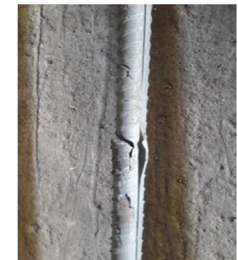
Şekil 5.3 Haddeleme sonrası tezgahtan ayrılan kusurlu çelik çubuk
