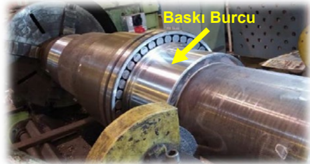
Şekil 16 Çıkış Kademe Milinin Rulmana Göre İşlenmesi
