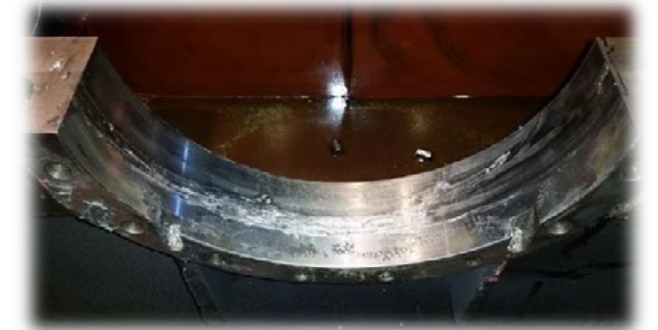
Şekil 11 Hasarlı Redüktör Gövdesi
