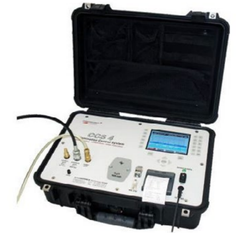
Şekil 7. Örnek bir Flushing Ünitesi ve Mobil Kirlilik Ölçüm Cihazı Görünümü
