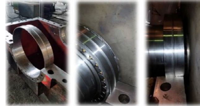
Şekil 19 Gövdede Flanşın Oturacağı Yerin İşlenmesi
