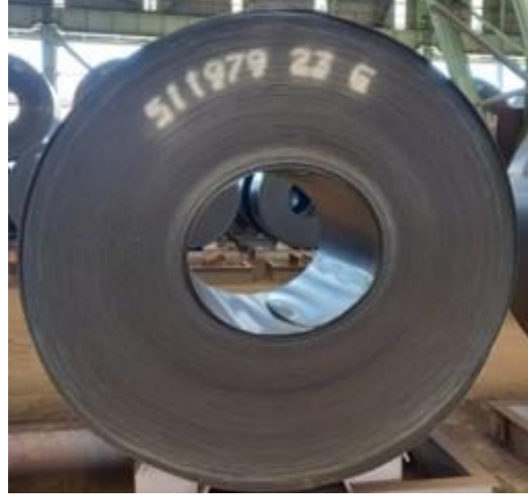
Şekil 1. Göçük kusuru oluşmuş bir bobin.
