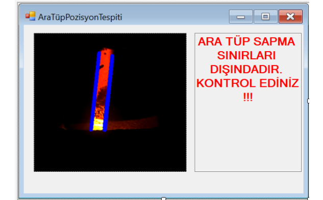
Şekil 8. Online Görüntü İşleme Uygulaması- Ara Tüp Pozisyonu Uygun Değil
