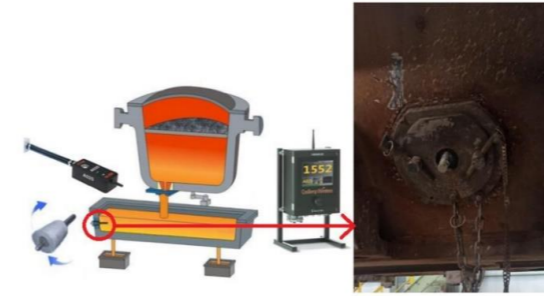
Şekil 2 Tandışte sürekli sıcaklık ölçer sisteminin monte edildiği bölge
