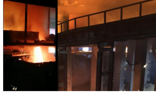
Şekil 13. Torpedoya Sıvı Ham Demir Akışı.
