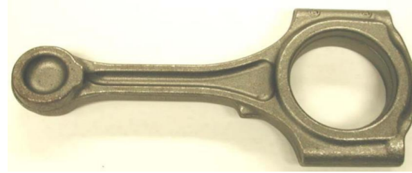
Şekil 2. Dövme yöntemiyle C70S6 çeliğinden üretilmiş biyel kolu [14].
