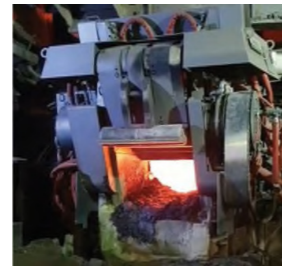
Figure 2. Thor 3K Automatic Slag Door
