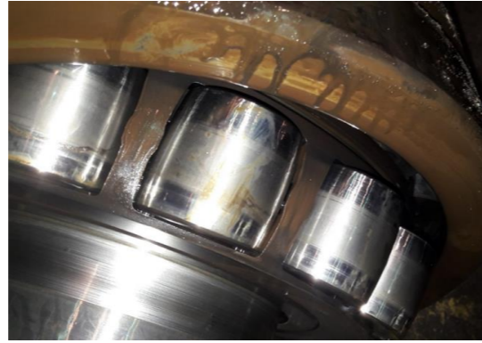
Resim 3. Redüktör giriş mili rulmanı değişimi ve redüktör eski rulmanı makaraları
