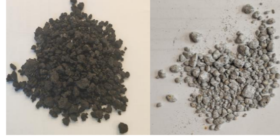
Şekil 1. Kaplama öncesi ve sonrası EAO cüruf granülleri.
