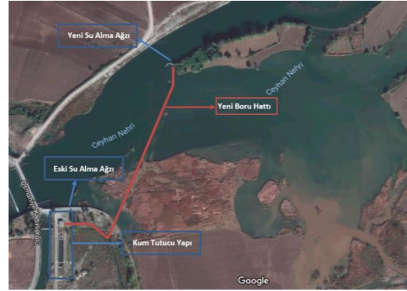
Şekil 4: Aslantaş su alma ağının yerinin değiştirilmesi
