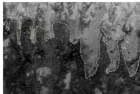
Şekil 15: Cüruf-Refrakter Etkileşim Bölgesi SEM Görüntüsü
