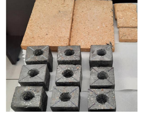
Şekil 1: MgO-C Refrakter Krozeleri ve Şamot Tuğla Kapakları
