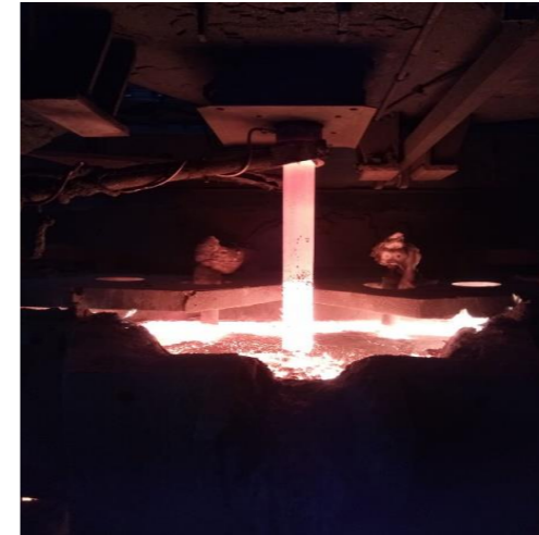
Şekil 2. Dökümde Kullanılan Ara Tüp
