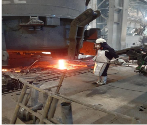
Şekil 7 Tandıştan geleneksel yöntem ile sıcaklık ölçümü yapılırken
