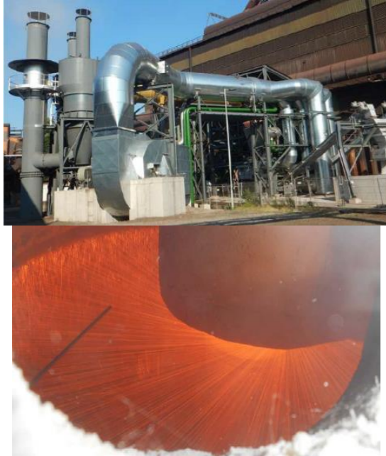
Şekil 15. Üstte, Voelstalpine Stahl tesisinde kurulan pilot tesis[1] Altta, Pilot tesiste granülatörün çalışması.[1]
