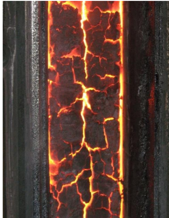
Şekil 1. Koklaşması tamamlanmış fırın.
