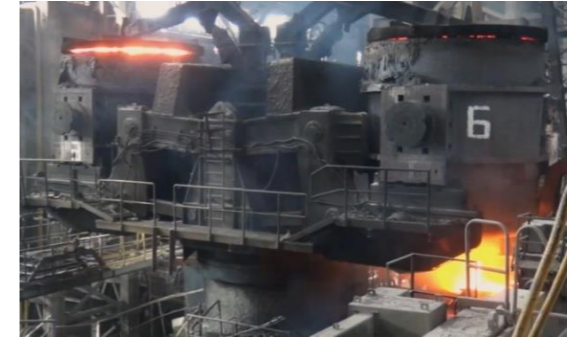
Şekil 1. Döküm ve Yükleme Pozisyonunda Pota Taşıyan Taret Sistemi
