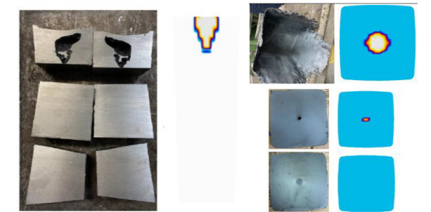
Şekil 12. Kare kalıp mod'da deneysel üretilen ingotun kesitleri ile simülasyon sonuçlarındaki kesit görüntülerinin karşılaştırılması.
