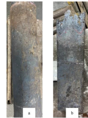
Şekil 10. VIM ocağında üretilen ingotlar: a) yuvarlak kalıpta b) kare kalıp mod'da.
