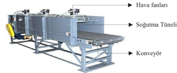
Şekil 3. Dövme prosesinde kullanılan soğutma sistemi.
