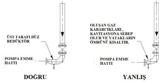
Şekil 1. Emiş hatlarında eksantrik redüktör kullanımı ile ilgili görsel.
