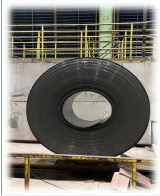
Şekil 1. Göçük kusuru oluşmuş bir bobin.
