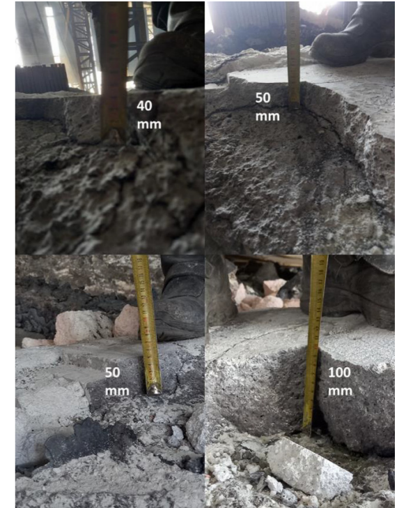
Şekil 9. Vuruş ve orta bölgeden çıkarılan taban bloğunun kesit görüntüleri
