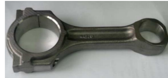
Şekil 3. Kırarak ayırma işlemi için çentik açılmış C70S6 çeliğinden üretilmiş biyel kolu [5].
