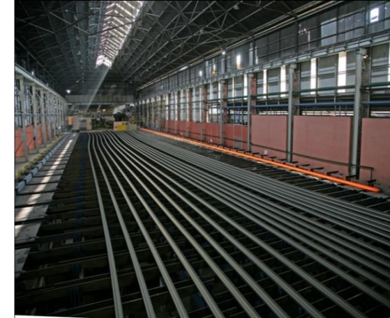
Şekil 1. Ölçü kontrolünden sonra mamullerin soğutulduğu ızgara.
