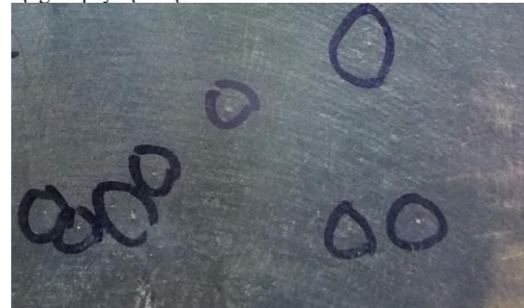
Şekil 1. Kütük Makro İncelemesinde Tespit Edilen Makro İnküzyon Kusuru
