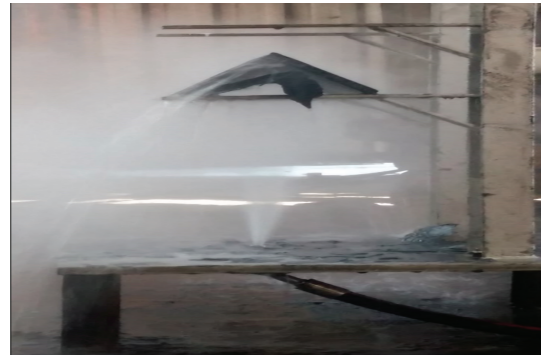
Şekil 3.3. 130x130x13 mm köşebent profilin 350 mm nozul mesafesindeki Nozul 1 ile su verme işlemi
