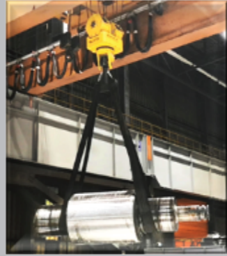
Elektrik Dönüştürücü Kanca Bloğu
