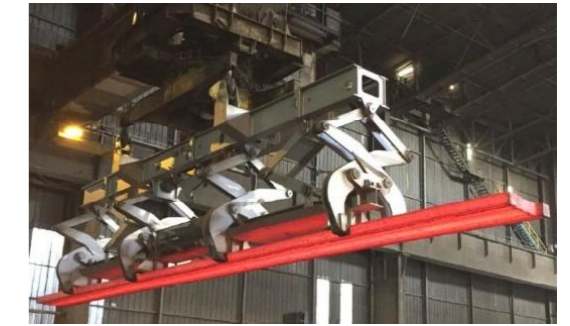
Şekil 9. Tav fırınına sıcak şarj aparatı
