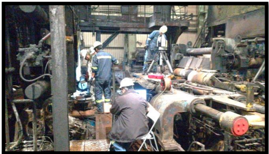
Resim 5. Cradle roll pivot şasi işleme öncesi referans alma
