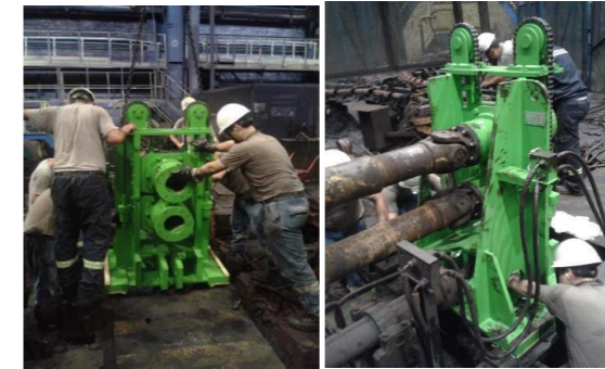
Resim 8. Shaft Tutucu Demontaj-Montajı
