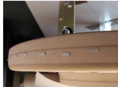
Şekil 4. Disk üzerine oluşturulan yapay kusurlar.
