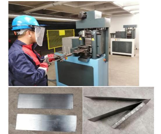
Şekil 4. Soğuk haddeleme besleme ve çıkış görüntüleri.
