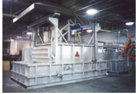
Şekil 12: Mekanik sirkülasyon pompası ile desteklenmiş balkonlu Reverber fırını
