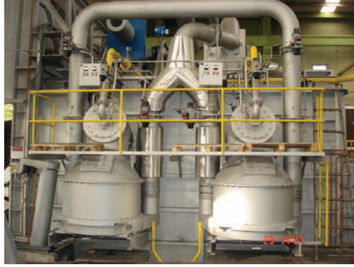
Şekil 5: Rejeneratif yanma sistemi (Sistem-Teknik)
