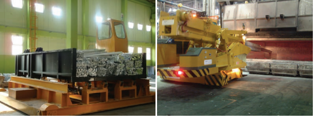
Şekil 4: Şarj arabası (Sistem-Teknik) ve mekanize curuf çekme (Tomorrow-Technology)
