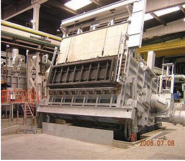
Şekil 13: İkiz kamaralı fırın (Sistem-Teknik)
