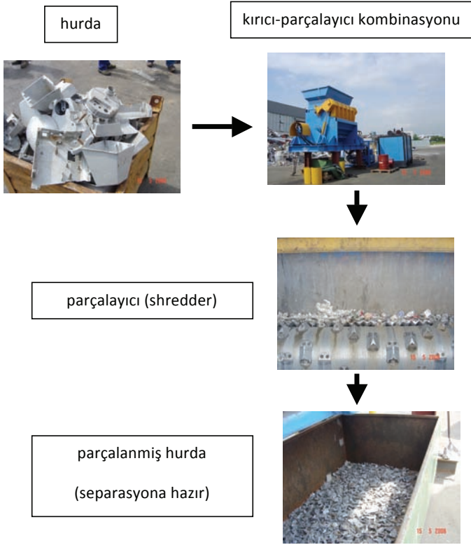
Şekil 3: Şematik mekanik hurda hazırlama
