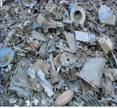
Şekil 20: Döner fırın için tipik hurda ve şarjı (Dross engineering)
