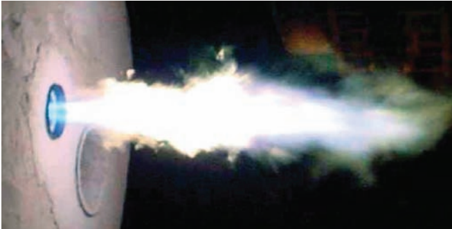
Şekil 7: Yanma havası olarak oksijenin kullanıldığı yakıcı
