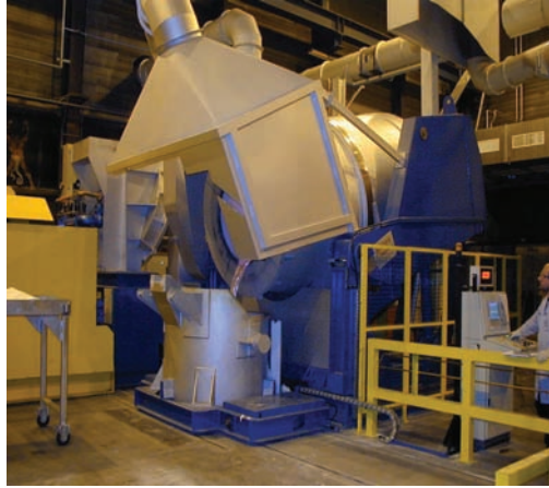
Şekil 18: Devrilebilir döner fırın (Dross Engineering)
