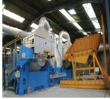
Şekil 20: Döner fırın için tipik hurda ve şarjı (Dross engineering)
