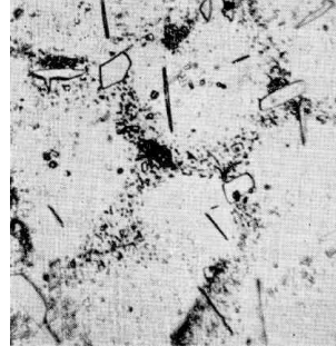
Şekil-5.7: 25 Cr / 20 Ni (0.10 C)'lu Elektrod Kullanılarak 780°C'da 100 Saat Tutulan Malzemede Oluşan Sigma Fazı Görüntüsü (x1600)
