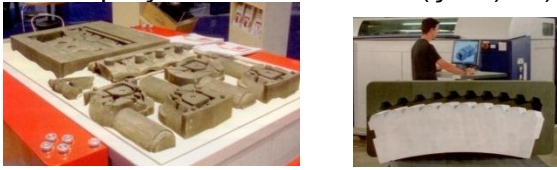
Şekil 34 : 3D baskı tekniği ile maça yapılması
