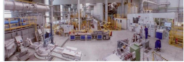
Şekil 40 : Metalin aktarılmadığı modern bir alüminyum silindir kafası döküm fabrikası İş akışı optimizasyonu ve elektronik data toplamanın yoğun uygulandığı kağıtsız bir fabrika. (Şekil 41)
