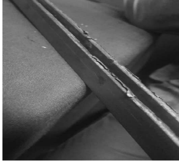
Şekil 7. Sıcak Yırtılma Sonrası Malzemenin Görüntüsü
