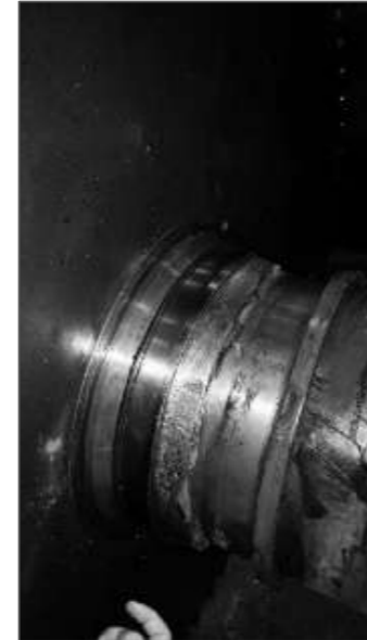
Şekil 6. Hasarlı redüktör mili
