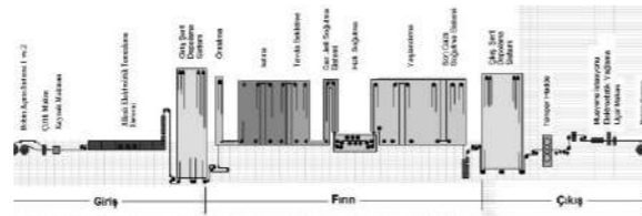
Şekil 4. Sürekli Tavlama Hattı Prosesi
