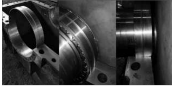
Şekil 9. Rulman yatağı segmanlı burçlu hale dönüştürüldü
