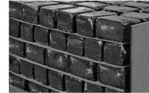
Resim 2: YF'de kullanılan döküm deliği çamuru
