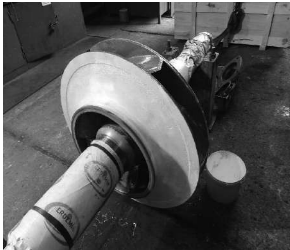
Resim 5. Pompa fanının 1. ve 2. Kat Seramik Kaplama Uygulanmış Durumu
