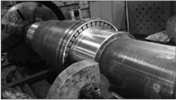
Şekil 10. Çıkış kademe milinin rulmana göre işlenmesi
